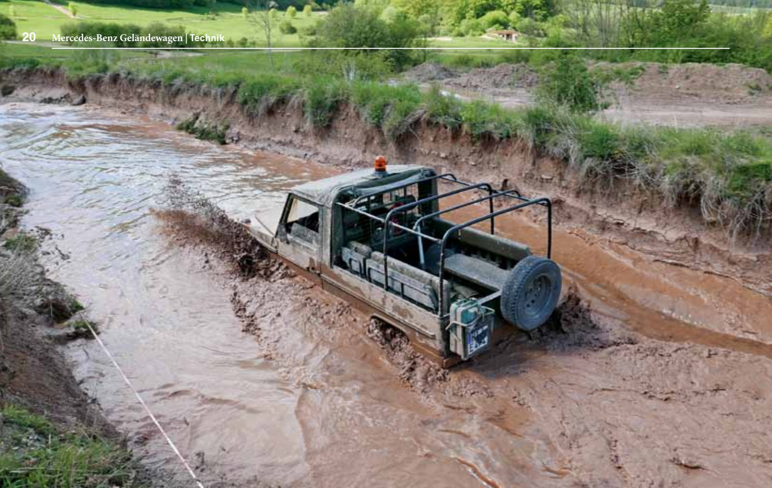
Oben: Belastungstest für den Kühler. Hier geht es mit dem G durch ein Schlammbad im Mammutpark. Bild: M. Spieth, 2017
