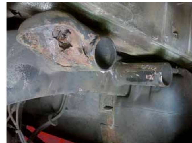
Bild 3 Das Heraustrennen des Altmetalls bedarf einer Salamiattaktik. Es geht mit einem Trennschleifer, auch ohne die Karosserie abzuheben. Dies ist allerdings nichts für übervorsichtige Menschen. Eine 230er Scheibe in der kleinen (regelbaren) Flex hilft sehr
