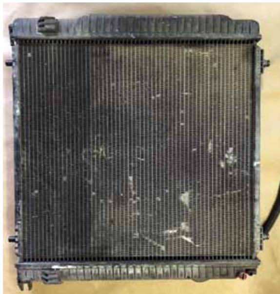
Unten links: Der alte Kühler des 500 GE mit sichtlichen Schadstellen.
