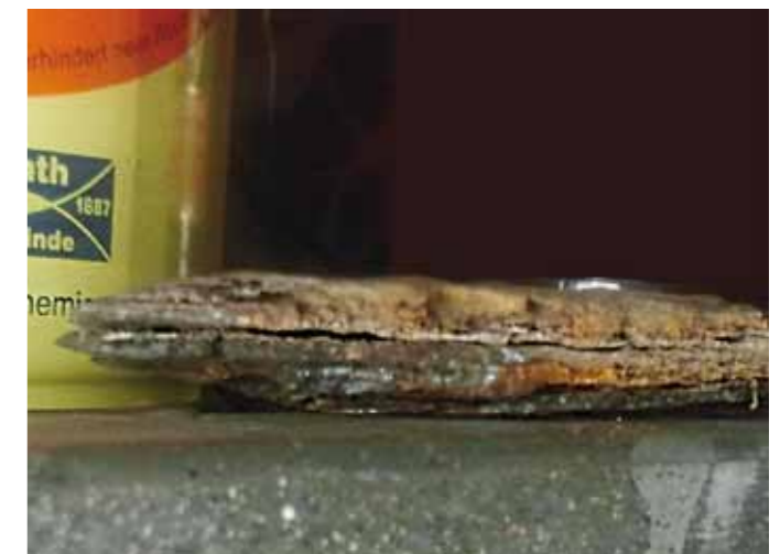
Bild 4 Das ist ein Paket Rost. Nicht etwa zwei Pakete übereinander. Es lag auf der Federkonsole obendrauf. Ich habe da 5 mm dicke Pakete Blattrost abgeklopft. Die Problemzonen waren der Federteller innen zum Rahmen hin von oben her und die Stoßdämpferaufnahme von unten her. Man hätte so bestimmt noch eine Weile fahren können und wahrscheinlich hätte man es auch bei der HU nicht gesehen.
