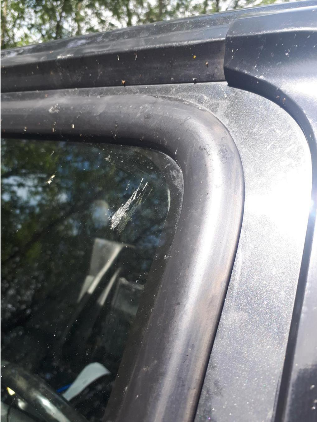
An der oberen Ecke die Fensterdichtung mit dem „Eisstiel“ abheben und WD40 oder anderes gummi-verträgliches Kriechmittel einlaufen lassen. So wird Wasser verdrängt und die Korrosion verzögert.
