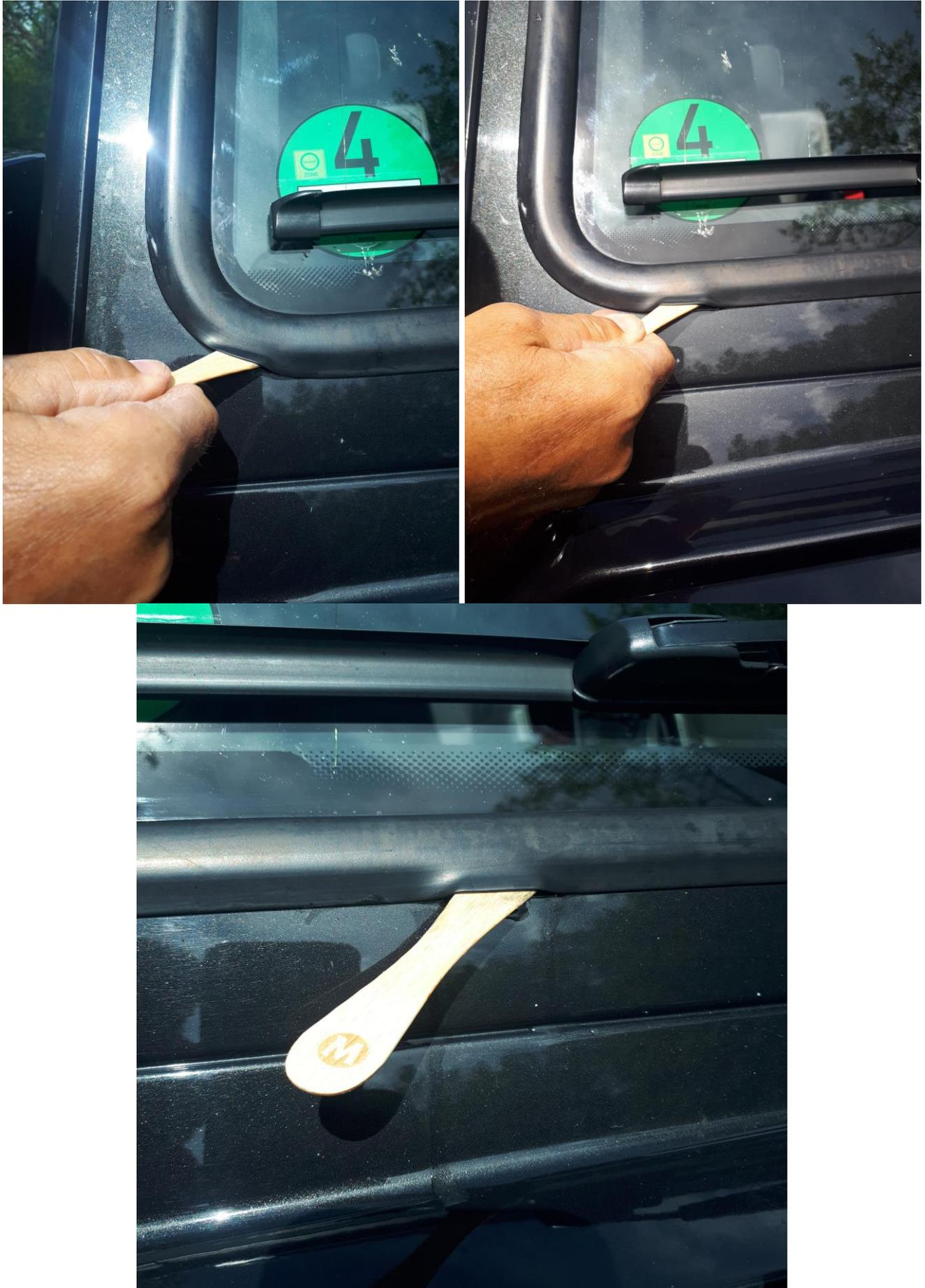
Auf Bild 3 sieht man das Wasser aus der Dichtung laufen.
