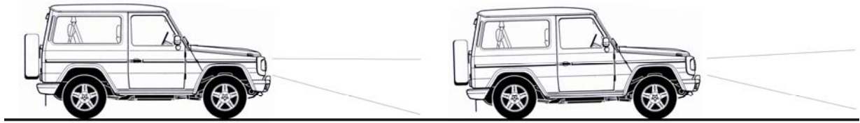
Bild 1: G unbeladen <-> G beladen ohne Leuchtweitenregulierung
